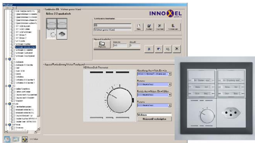
Schalterkombination mit Drehthermostat und deren Konfiguration mit der kostenlosen PC-Software zu NOXnet.
