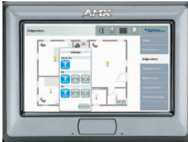
Bild 6 Touchpanel mit Schallfläche. Das Hintergrundbild wird aus der Parametriersoftware gewonnen. Berührt man einen Schalter auf dem Display, öffnet sich automatisch das Bedienungsfeld.
