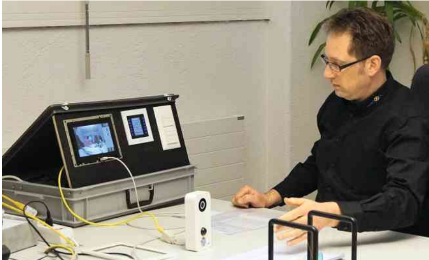
Auch das gehört zur Beratung. Hier testet Thomas Feller, wie gut sich das Türsprechsystem «DoorBird» ins Bussystem NOXnet integrieren lässt.
