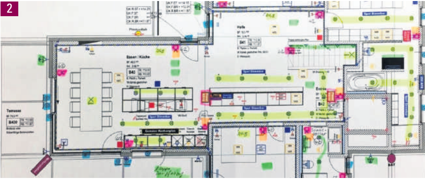
Elektroplan mit farbigen Markierungen: Pink für Taster, Gelb für Dimmer, Orange für Thermostate, Grün für Schaltaktore und Blau für Storen.
